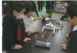
銅とステンレスの棒を同時に加熱し、比較することで、温まり方の共通点と差異点に気付くことができました。
