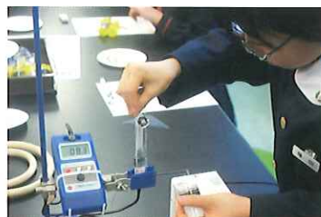
【磁力をテスラメーターで計測】
